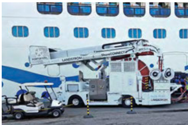
Die ganz großen Steckdosen. Die AIDAnova am 26. August 2023 vor dem Auslaufen aus Kiel an der Landstromversorgung. Foto: Felix Kolbeck
