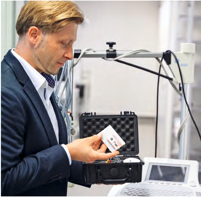
Prof. Dr. Christian Hanshans zeigt die kleine Platine des EKG-Bausatzes, die das Original-Laborgerät im Hintergrund ersetzen soll
