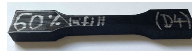
Abbildung 1: Flachzugprobe mit 60% Fülldichte
