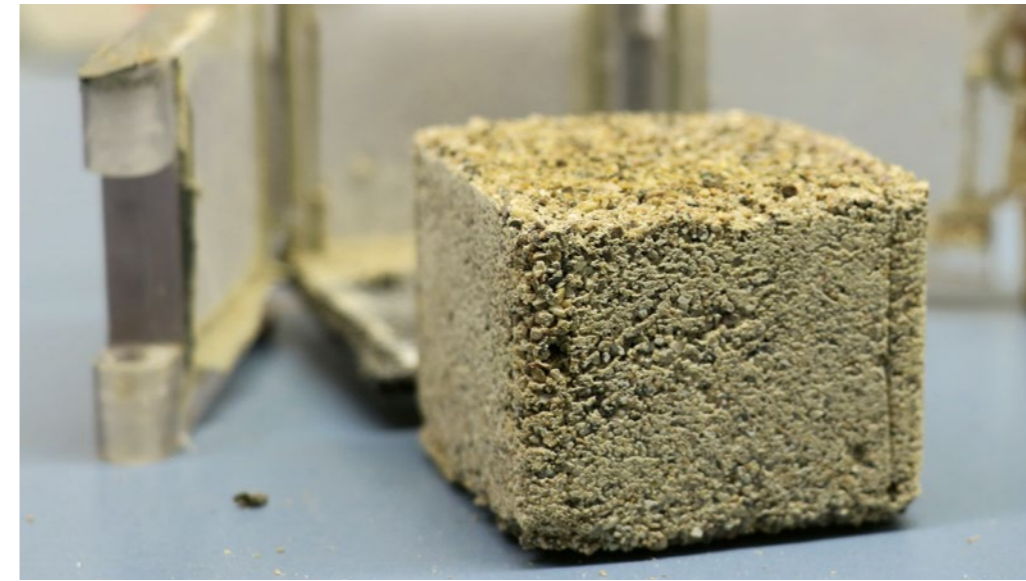
Eine durch Biozementierung verfestigte Sandprobe
