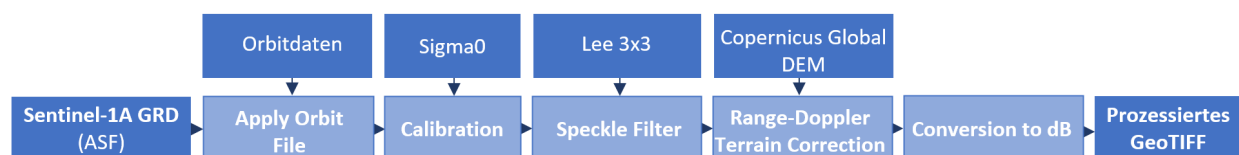
Abb. 1: Workflow zur Vorverarbeitung der Sentinel-1A Daten
