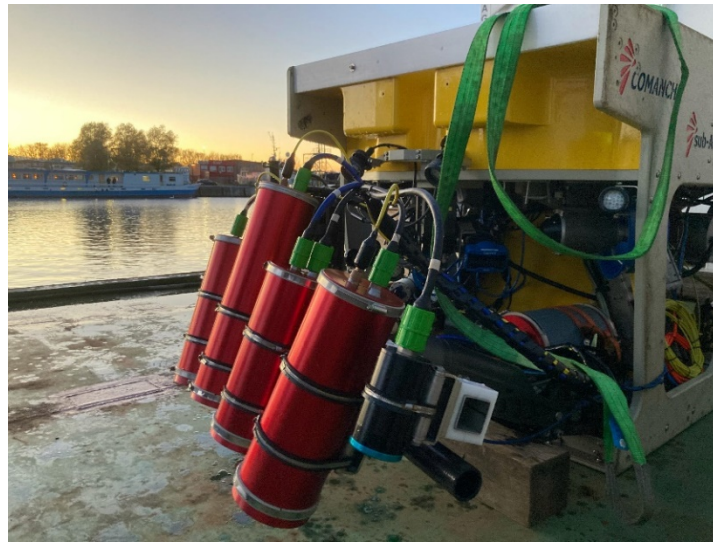
Abb. 1: UWSensor montiert im hydraulischen Manipulator eines Tauchroboters von Baltic Taucherei- und Bergungsbetrieb Rostock.
