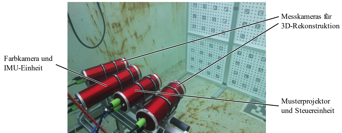
Abb. 2: UWSensor 3D-Sensorsystem in einem Wassertank bei Versuchen zur Kalibrierung.
