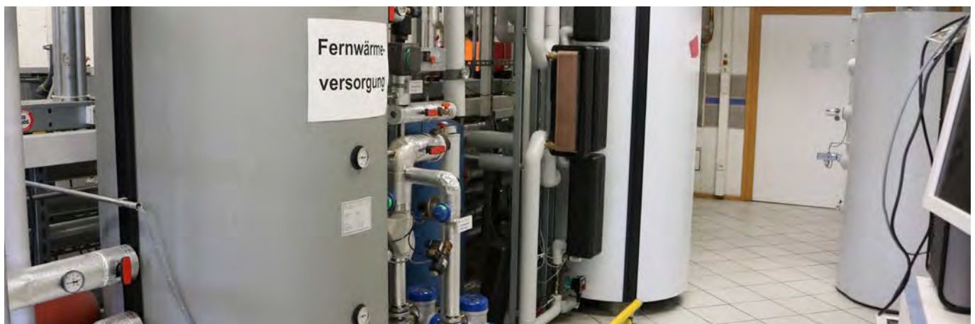
Bild 1: Prüfstand für Fernwärmeübergabestationen im Heiztechniklabor der Hochschule München
