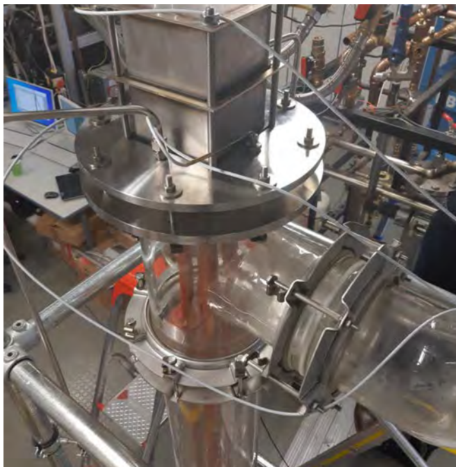
Abb. 3.: Versuchsaufbau zur Bestimmung der Wärmeübertragung bei der Fallfilm-Verdampfung des Kältemittels Wasser an strukturierten Rohren.
