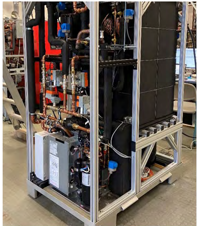
Abb. 4: Fließbild der Wärmepumpe mit integriertem Latentwärmespeicher, im Entladebetrieb mit serielltem Durchgang des Kältemittels durch Kondensator 1, Latentwärmespeicher und Kondensator 2 (links). Versuchsanlage (rechts) mit internem Wärmepumpenkreislauf (linke Frontseite) und Latentwärmespeicher (rechter Anlagenteil).
