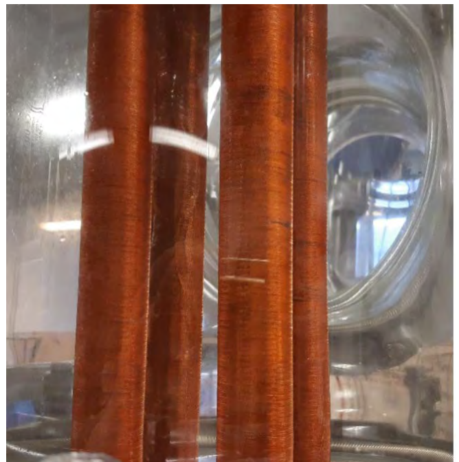
Abb. 3.: Versuchsaufbau zur Bestimmung der Wärmeübertragung bei der Fallfilm-Verdampfung des Kältemittels Wasser an strukturierten Rohren.
