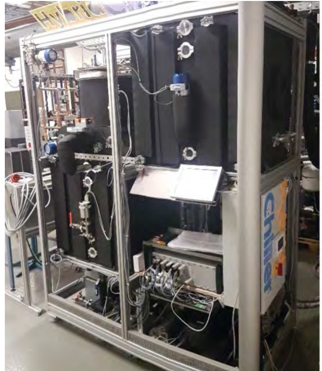
Abb. 1: Fließbild der Absorptions-/Kompressions-Kältemaschine mit Turboverdichter zwischen Verdampfer und Absorber oder Austreiber und Kondensator. Einsatz für 10 °C Kaltwassererzeugung mit Rückkühlung durch ein trockenes Rückkühlwerk mit Kühlwasservor-/ -rücklauf 37/45 °C. (links). Funktionsmuster der Hybridkälteanlage mit wissenschaftlicher Messtechnik in der Hardware-in-the-Loop-Teststandumgebung im Labor der Hochschule München (rechts)
