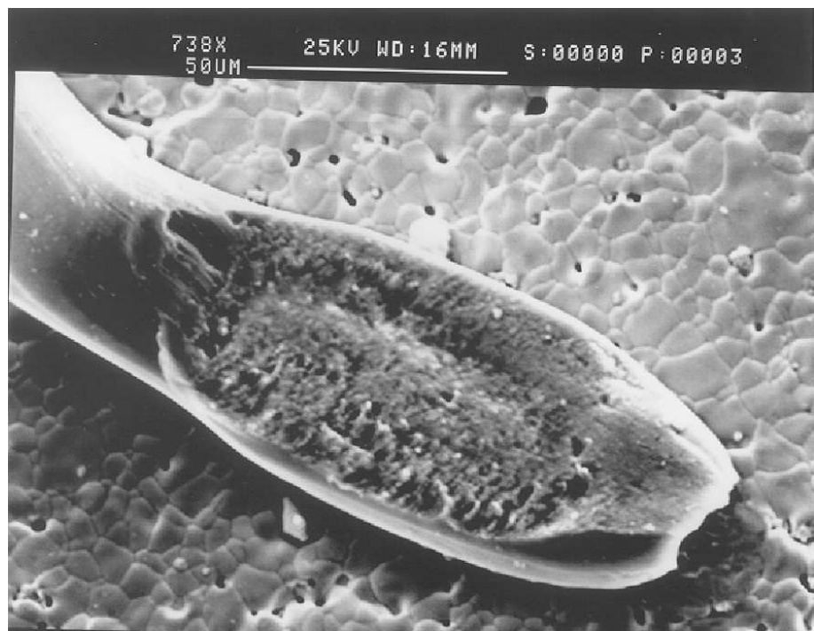
Eine gute zweite Al-Draht Wedge – Wedge-Bondstelle auf Silberleiterbahn
