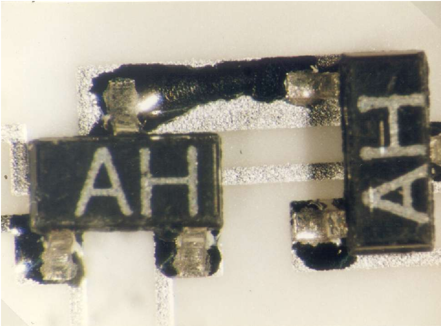
Keine ausreichende Menge an Lötzinn
