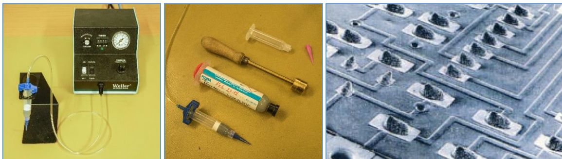
Abbildung 4: Dosiervorrichtung; Dosierspritze mit Nadel, Werkzeug zum Befüllen, mit Lotpaste, befüllte Dosierspritze; Leiterplatte mit Lotdepots
