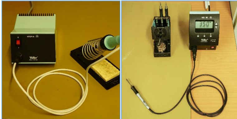
Abbildung 3: Lötstationen für Handlötarbeiten
