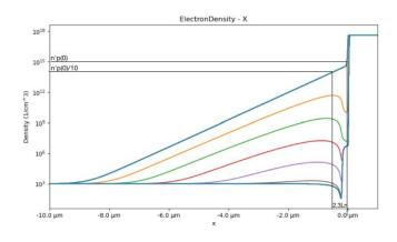
Dann soll das Schaltverhalten untersucht werden. Beim Ein- und Ausschalten eines Transistors müssen Sperrschicht- und Diffusionsladungen auf- bzw. abgebaut werden. Diese Vorgänge sollen in der Simulation nachvollzogen und mit den klassischen, in SPICE benutzten Transistormodellen verglichen werden.
