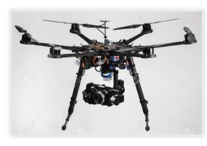
Im Rahmen des Projektes Technische Informatik soll eine technische Lösung auf Basis einer <u>Drohne</u> (Carbon Hexacopter) und einem Sensorsystem (FLIR- und RGBD-Kamera) entwickelt werden, die Rehkitze im Feld erkennt, lokalisiert und rettet. Ein studentisches Team hat im WiSe 2023/2024 erste
