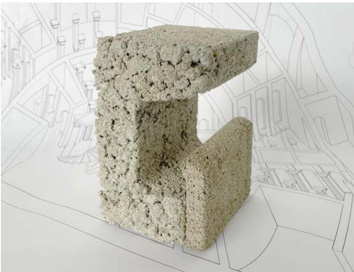
In den Wandquerschnitt integrierter Handlauf von Celine Deufel und Eva Wismeth
