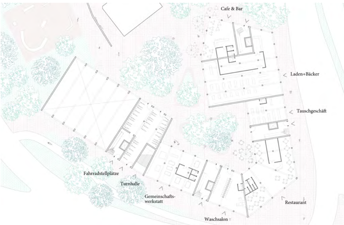
Erdgeschossgrundriss (orig. M=1:200) von Celine Deufel und Ramona Friedrichs
