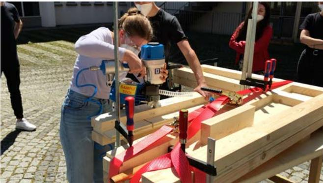
Herstellen der Versuchskonstruktion mit eingeschossenen Holznägeln. Foto: Christian Schühle
