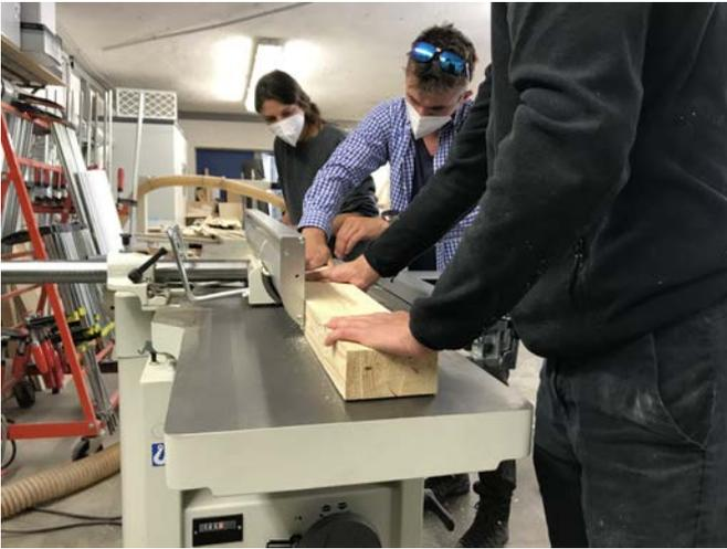
Abrichten des Vollholzes für die Probekonstruktion. Foto: Christian Schühle
