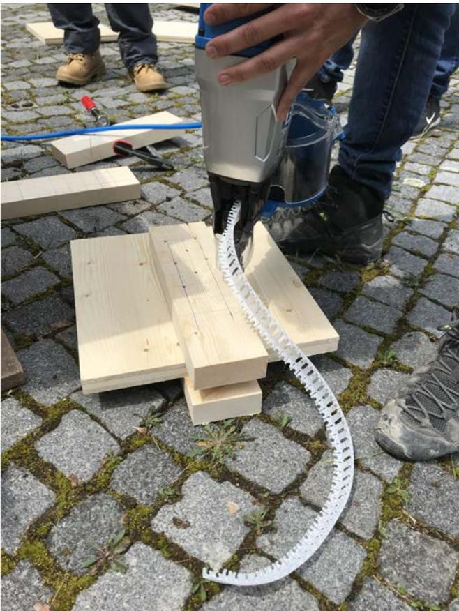
Herstellen eines Versuchskörpers für die Bauteilprüfung. Foto: Christian Schühle
