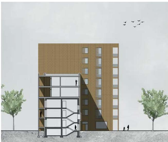
Schnitt durch das Bestandsgebäude und den aufgesetzten Holzbau
