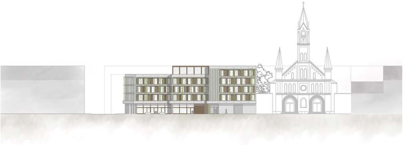
Das Konzept verbindet eine vertikale Begrünung mit einer Fassade aus Holz und Beton. Betonfertigteile und Holzelemente gliedern die Fassade und projizieren die Nutzung im Inneren nach außen. Die Spiegelung der Öffnungsflügel lockert das Fassadenbild auf.
