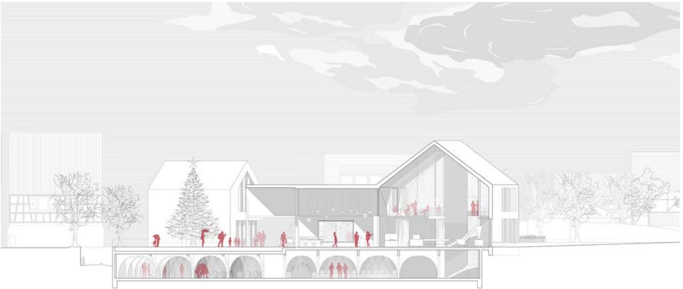
Schnitt durch den Verkauf und die Schnittstelle der Baukörper der Anlieferung und das Abfüllen, sowie durch die Lagerräume im Untergeschoss mit der Anmutung der typischen Gewölbekeller.
