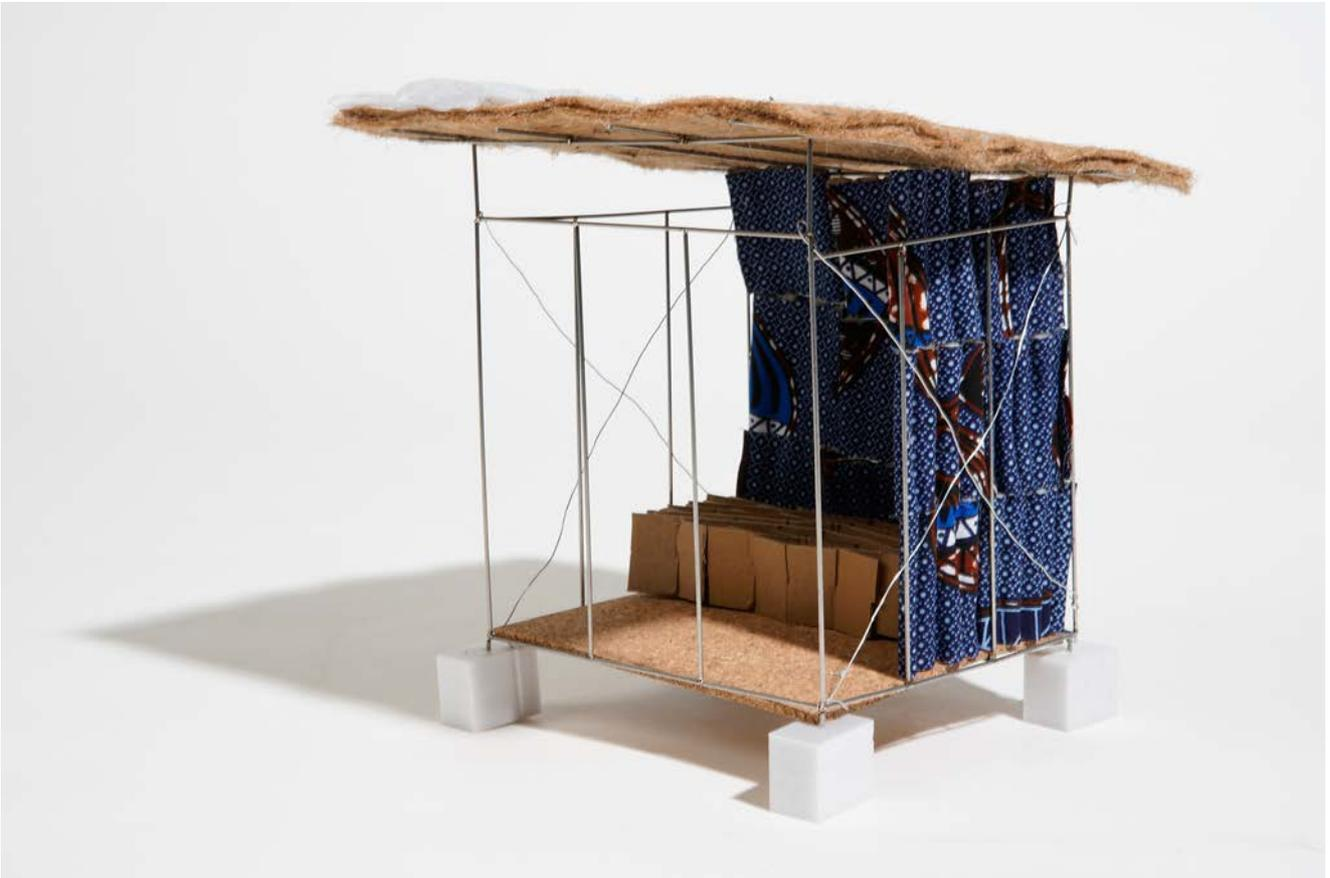
Die Hülle der Dämmmodule kann je nach Materialverfügbarkeit und monetärer Situation aus Jutesäcken oder anderen Textilien erstellt werden. Der Stoff wird zu Röhren genäht, welche mit den unterschiedlichsten Materialien (Plastikmüll, Elefantengras, etc.) gefüllt werden können; Projekt: Shelter 2.0, Victoria Reiter, Sarah Schernthaner
