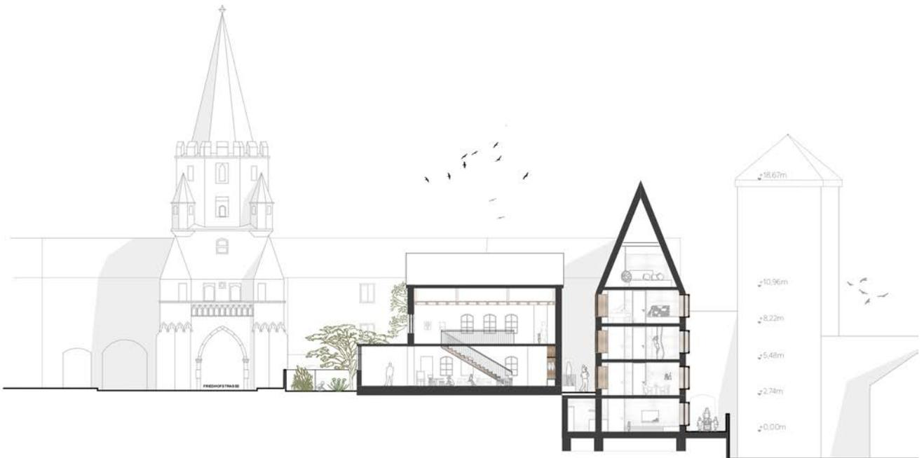
Querschnitt S02 durch bestehende Bürstenfabrik und Neubau
