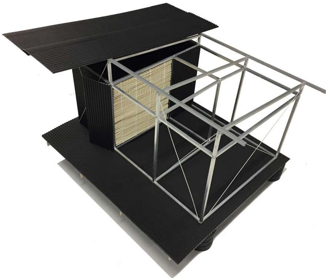
Die Bauweise basiert auf einem pavillonartigen Stecksystem mit Konstruktionshilfen aus recyceltem Kunststoff und Aluminium-Profilen aus dem Trockenbau. Komplexe Details werden vermieden und Verbindungen und Eckpunkte sind möglichst simpel gelöst; Projekt: Florian Kaiser, Philipp Kohl
