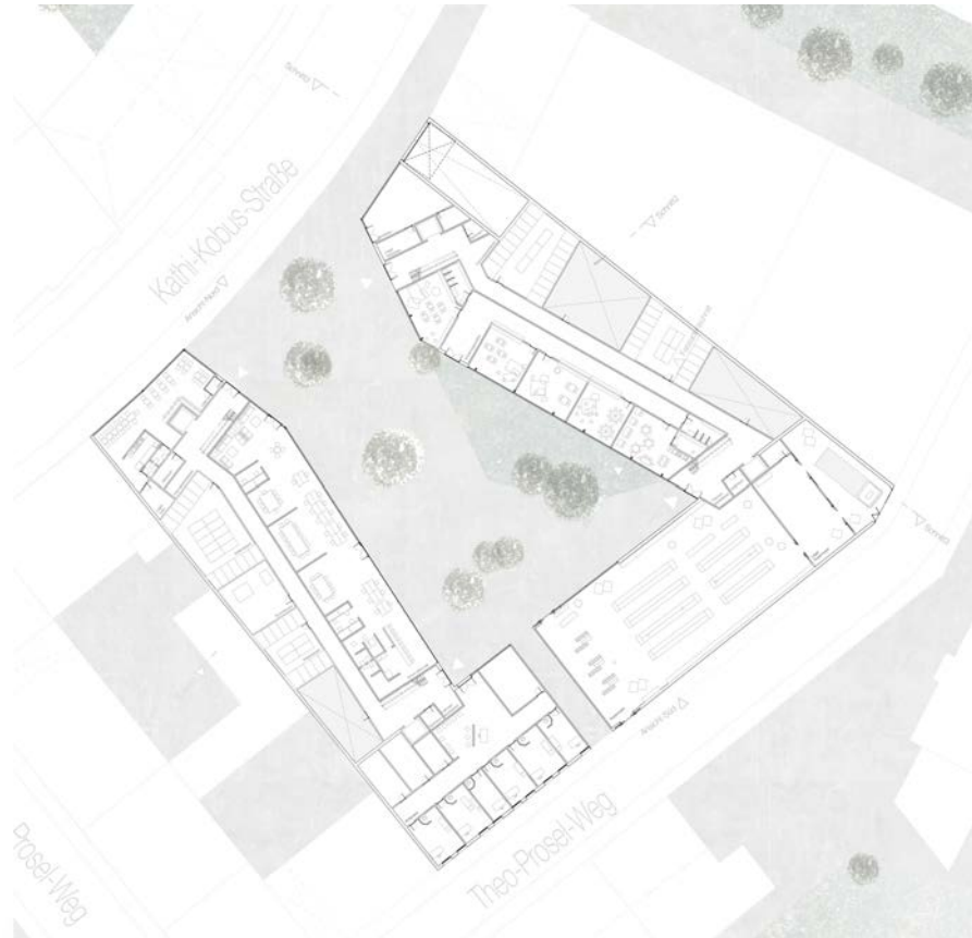
Grundriss EG: Im Erdgeschoss befinden sich die öffentlichen Nutzungen, die auf die Bedürfnisse des Quartiers reagieren: Supermarkt, Kita, Apotheke, Arzt und Café.
