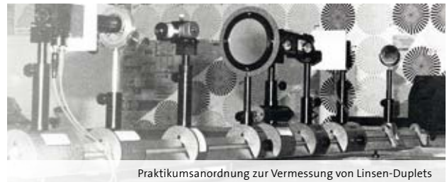
Praktikumsanordnung zur Vermessung von Linsen-Duplets
