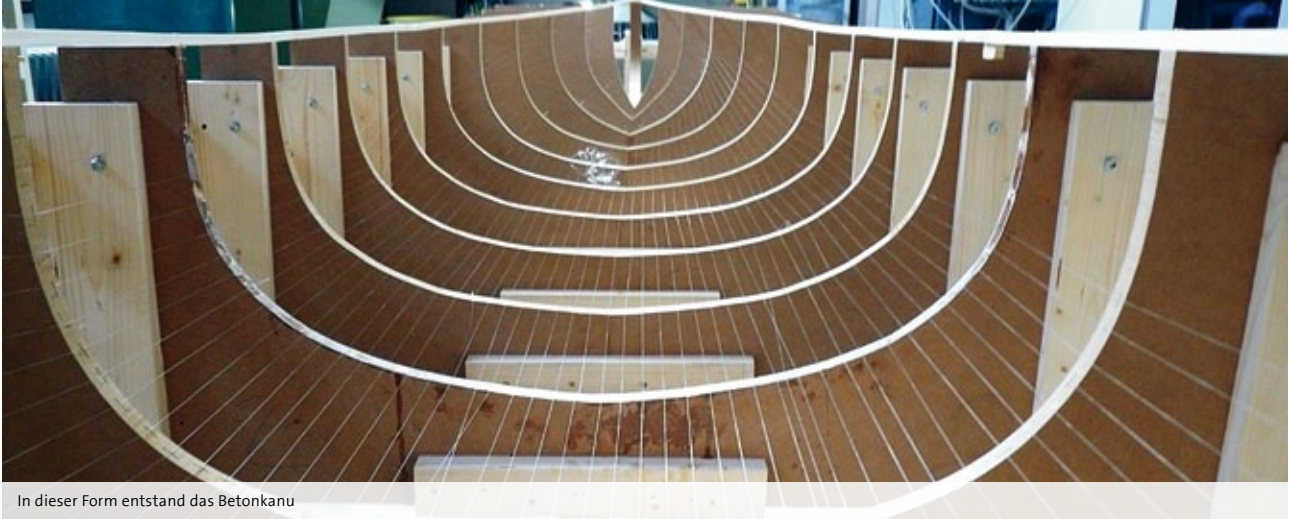
In dieser Form entstand das Betonkanu
