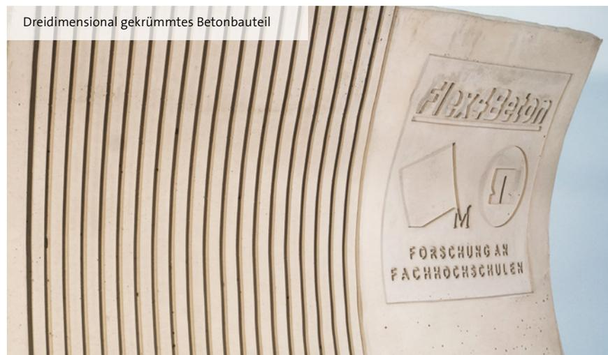
Dreidimensional gekrümmtes Betonbauteil
