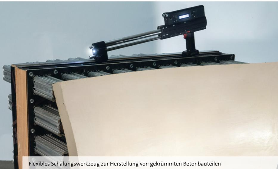
Flexibles Schalungswerkzeug zur Herstellung von gekrümmten Betonbauteilen
