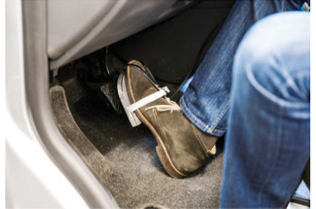
Der Bremskraftmesser kann für jeden Schuhtyp und jede Größe verwendet werden
