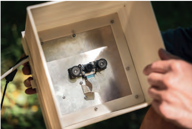
Eine winzige Infrarotkamera erfasst den Ein- und Ausflug der Bienen
