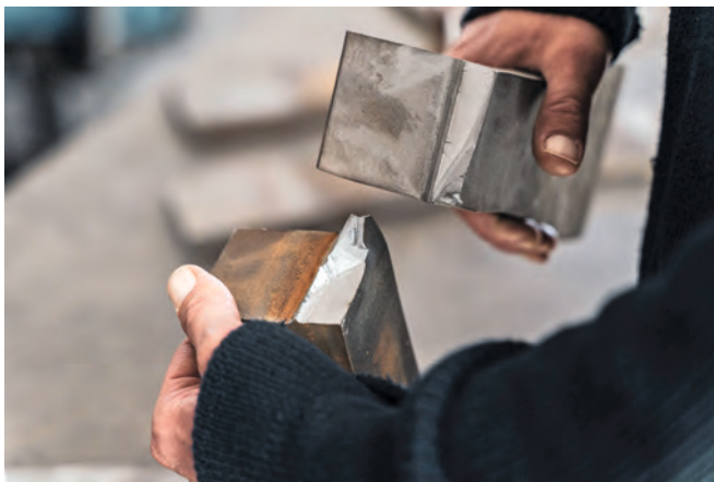
Bei dieser Bruchfläche prüfen die Forscher:innen, ob es einen speziellen Grund für die Rissentstehung gibt – zum Beispiel Unregelmäßigkeiten im Werkstoff oder einen Fertigungseinfluss
