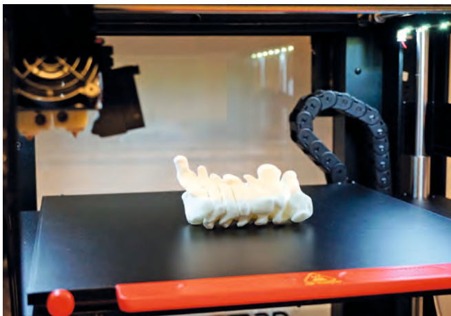
3D-Drucker verwandeln die digitalen 3D-Modelle in „echte“ Knochenmodelle zum Anfassen
