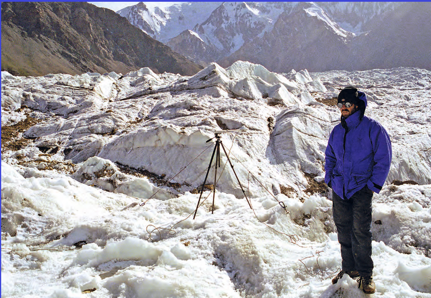
Messung der Oberflächenreflexion auf dem Muskulak-Gletscher im tadschikischen Pamir-Gebirge
