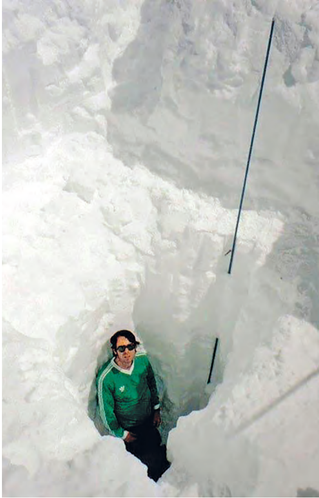
Schneescharte zur Messung der winterlichen Akkumulation auf dem Vernagtferner, Tirol
