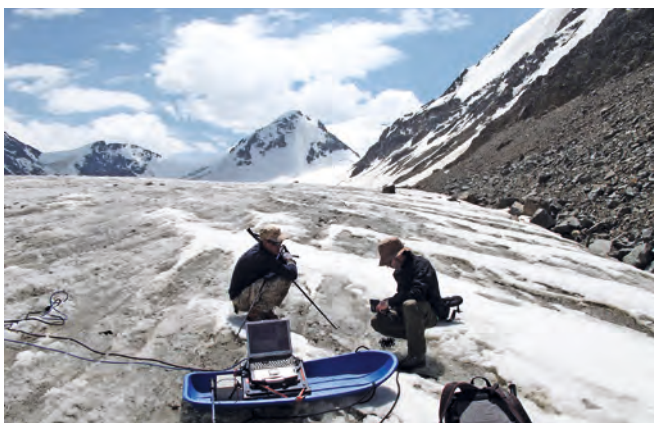
Radarmessung zur Bestimmung der Eisdicke im Ak-Schyirak Massiv, kirgisischer Tianschan
