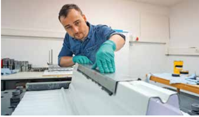
Florian Ilg, wissenschaftlicher Mitarbeiter am Institut für Material- und Bau- forschung, bringt eine klebtechnische Verstärkung an auf einem Modell der Deckenunterseite eines Parkhauses
