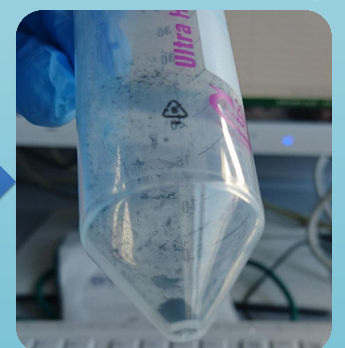
Sedimentierte AgNPs nach Trocknung
