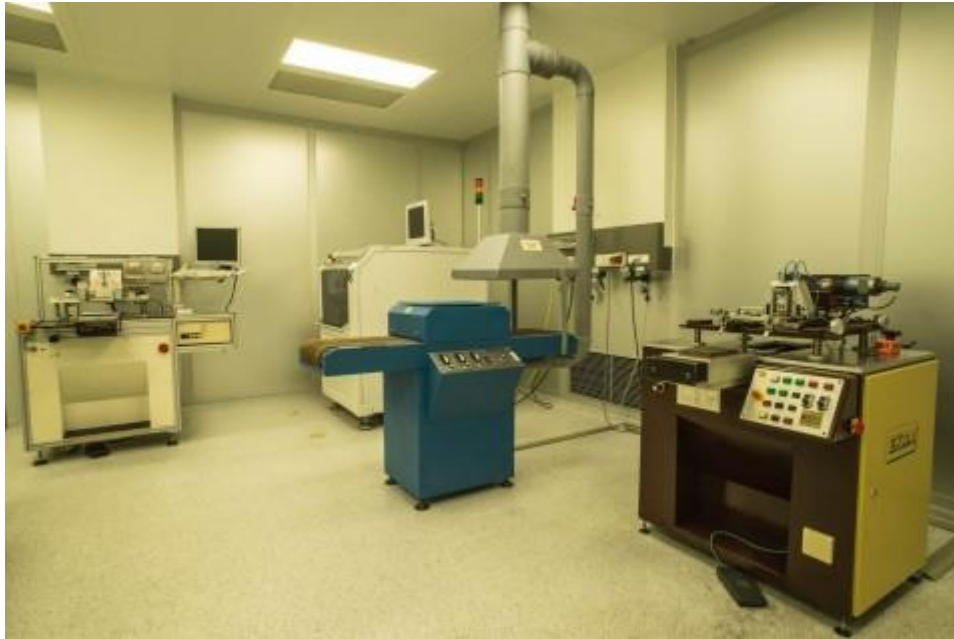
Figure 2: Reinraum an der FK04 der HM mit Siebdruckmaschinen und co.
