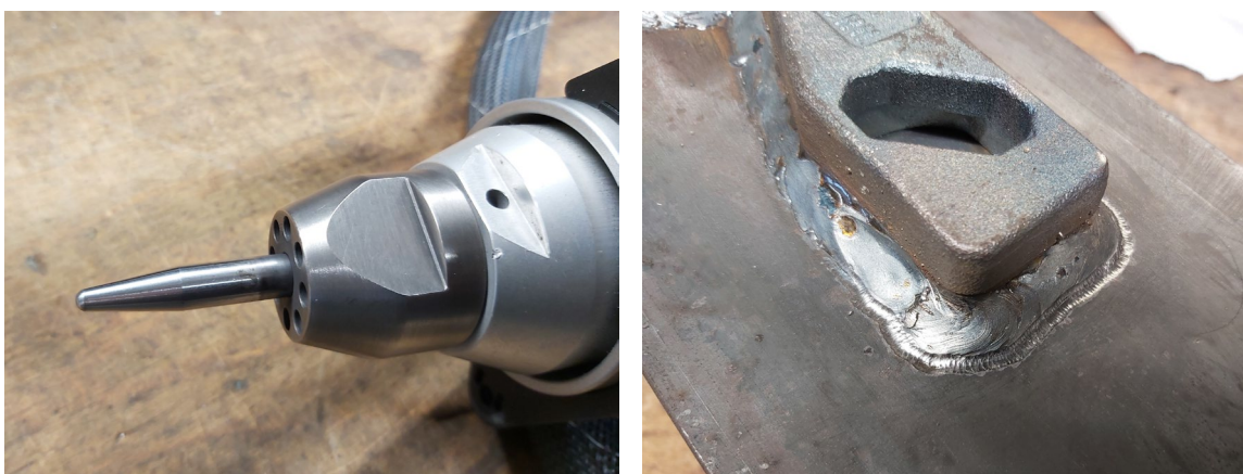
Abbildung 2-1: Links) Schlagbolzen eines HFH-Geräts, rechts) HFH-nachbehandelter Nahtübergang einer aufgeschweißten Schienenklemme
